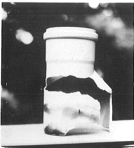
Plasticrør gennemgnavet af kloakrotter. Røret har dannet afløb fra en køkkenvask i en villa.
